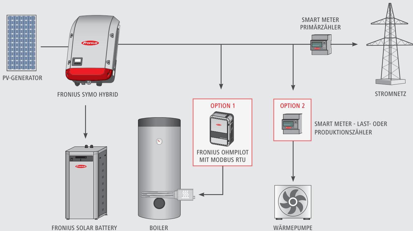
**Option 1:** Ohmpilot über Modbus RTU mit einem Fronius Smart Meter (Primärzähler)
