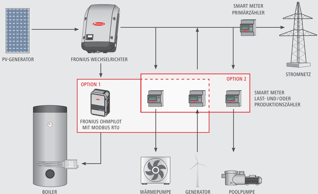
**Option 1:** Ohmpilot über Modbus RTU mit drei Fronius Smart Meter (einer davon Primärzähler)
